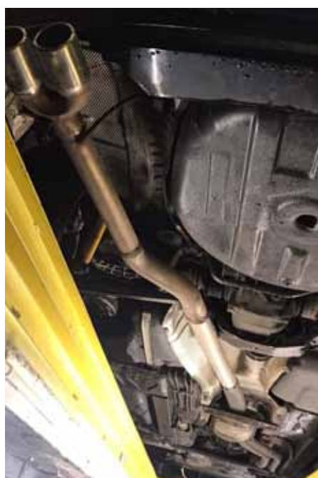
Rohre statt Schalldämpfer.
