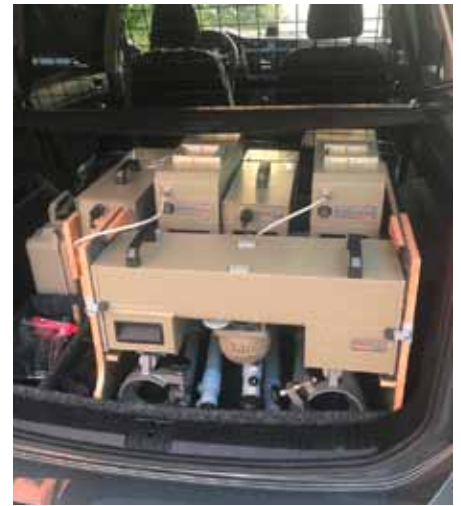
Neueste Technologie: das neue ESO-System kommt bei der mobilen Geschwindigkeitsmessung zum Einsatz.
