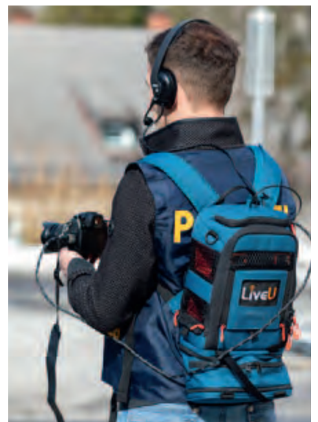
Die mobile Einheit lieferte gestochen scharfe Bilder mit einer permanenten Datenrate von 18 Mbit/sec.
